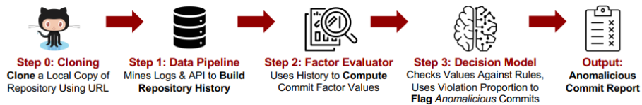
图 12 恶意代码提交的检测框架 Anomalous [29]
